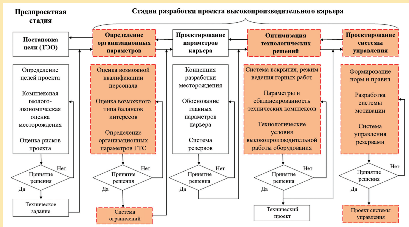
Рис. 2. Стадии проектирования и состав проектов высокопроизводительных горно-технических систем карьеров.
