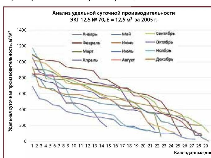
Рис. 3. Показатели работы экскаваторов ЭКГ 12,5 № 70; ЭКГ 12,5 № 67; РН 2300 № 492 на Сибиргинском разрезе (2005 г.)
