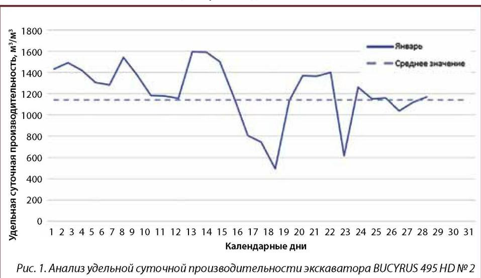
Рис. 1. Анализ удельной суточной производительности экскаватора BUCYRUS 495 HD №2
