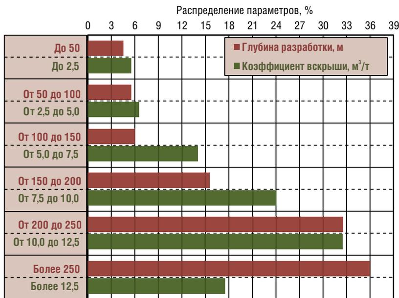
Рис. 2. Распределение параметров угольных разрезов России
