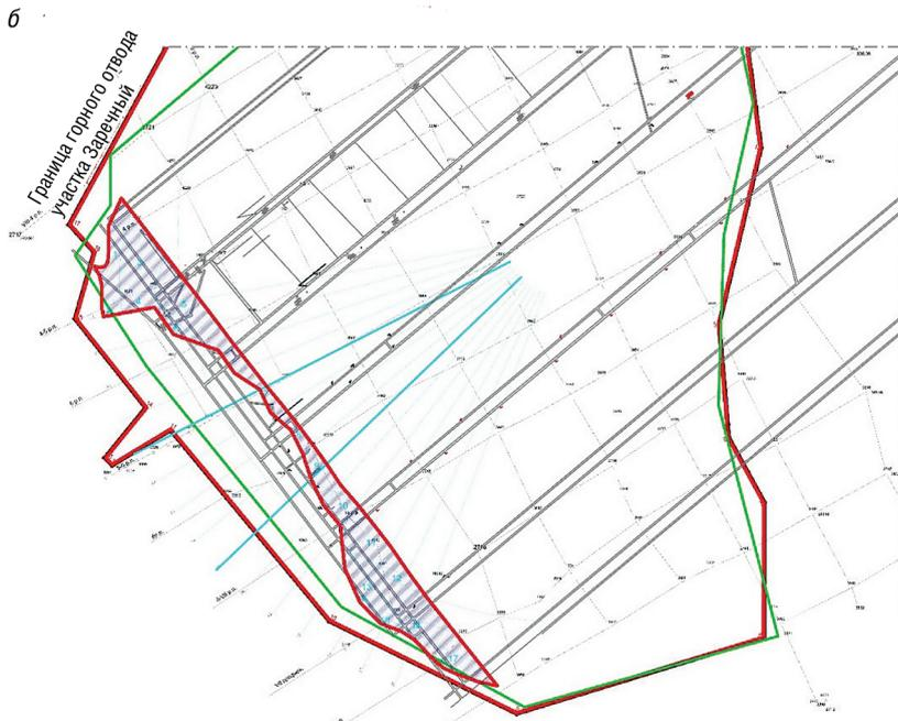
Рис. 3. Схема расчета безопасных расстояний для БВР (а) и местоположения целика для обеспечения безопасности подземных горных работ (б)
