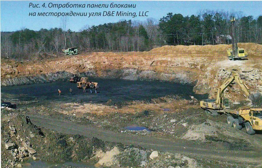
мобильным транспортом на внутренние отвалы. Погрузка вскрышных пород осуществляется гидравлическими экскаваторами с емкостью ковша от 1,5 до 10 куб. м (рис. 4).
